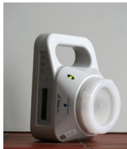
NIR-Spektrometer zur zerstörungsfreien Qualitätsanalyse von Früchten
