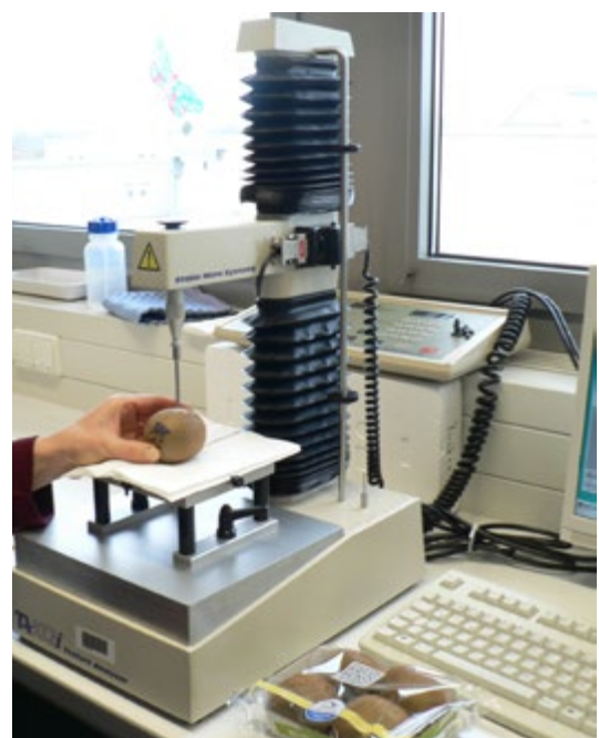
Penetrometer - Festigkeitsmessung (Foto: S. Bliedung)
