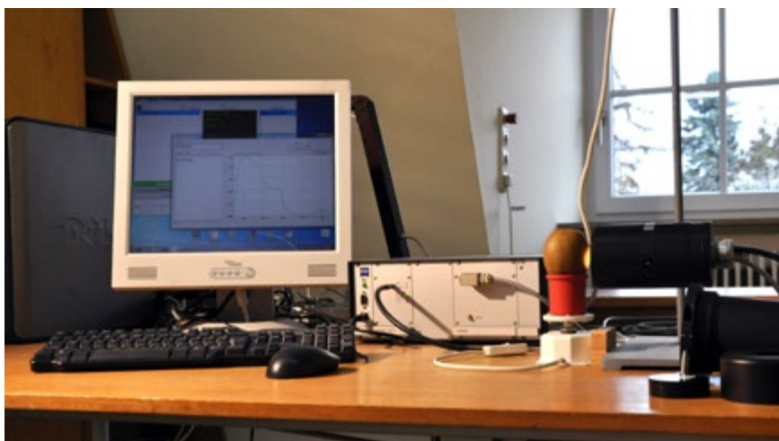
NIR-Spektrometer zur zerstörungsfreien Qualitätsanalyse von Früchten
