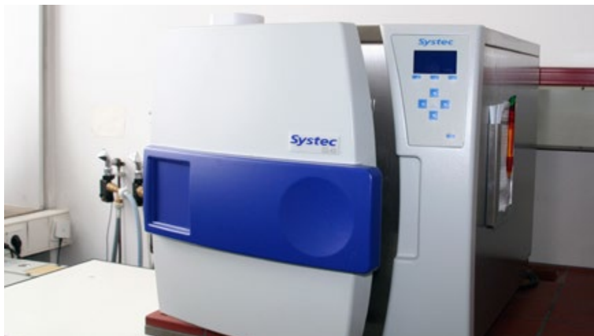
Autoklav zur Dampfsterilisation von Nährmedien, Puffern, mikrobiologischen Abfällen
