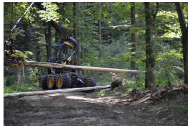
Abb. 2: Entrindender Harvesterfällkopf im Einsatz
