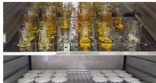
Abb. 7: Lagerversuche mit flüssigem Leinöl bzw. mit den Ölpulvern
