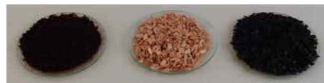
Abb. 1: HTC-Kohle (links) und Pyrolysekohle (rechts) hergestellt aus Buchenholzhäcksel (Mitte)
