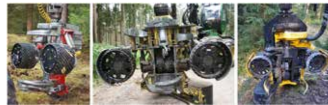
Abb. 1: Prototypen im Projekt „Debarking Head I“, von links nach rechts: Log Max 7000 C, John Deere H 480 C, Ponsse H7
