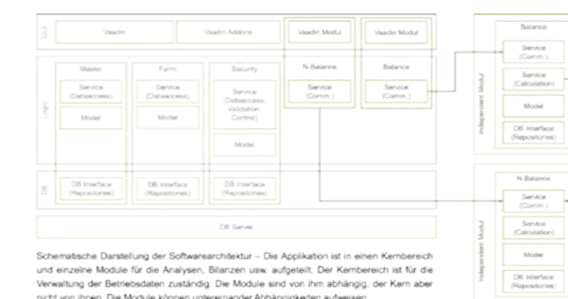
Abb. 2: Schematische Darstellung der Softwarearchitektur
