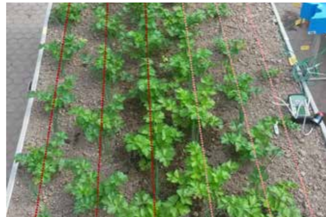
Abb. 3: Filmbewässerung mit zwei unterschiedlich aufgebauten Kapillaren (links: ummantelt, rechts: nicht ummantelt)
