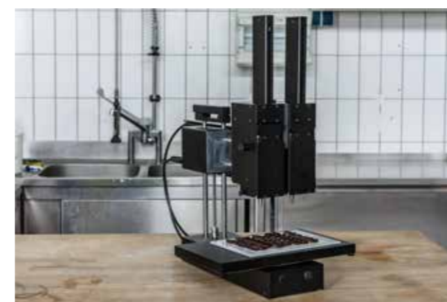
Abb. 1: Weltweit erstes Mehrkopf 3D Food Printing System mit dem bereits erfolgreich verschiedene Lebensmittel aus mehreren Komponenten hergestellt werden konnten
