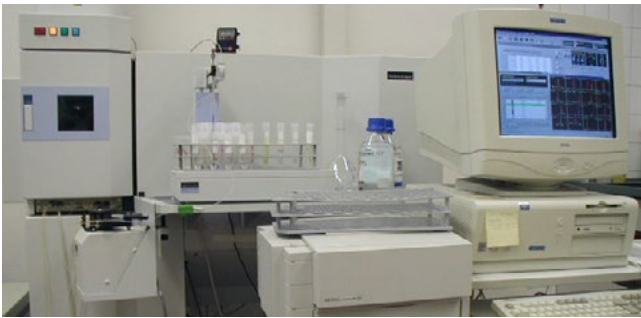
Abb. 1: ICP-OES zur Makronährstoff-Bestimmung
