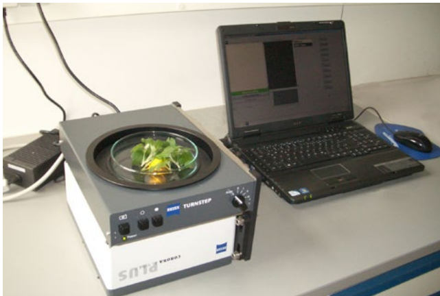
Abb. 1: Messung des N- und KH-Status von Stecklingen mittels NIRS
