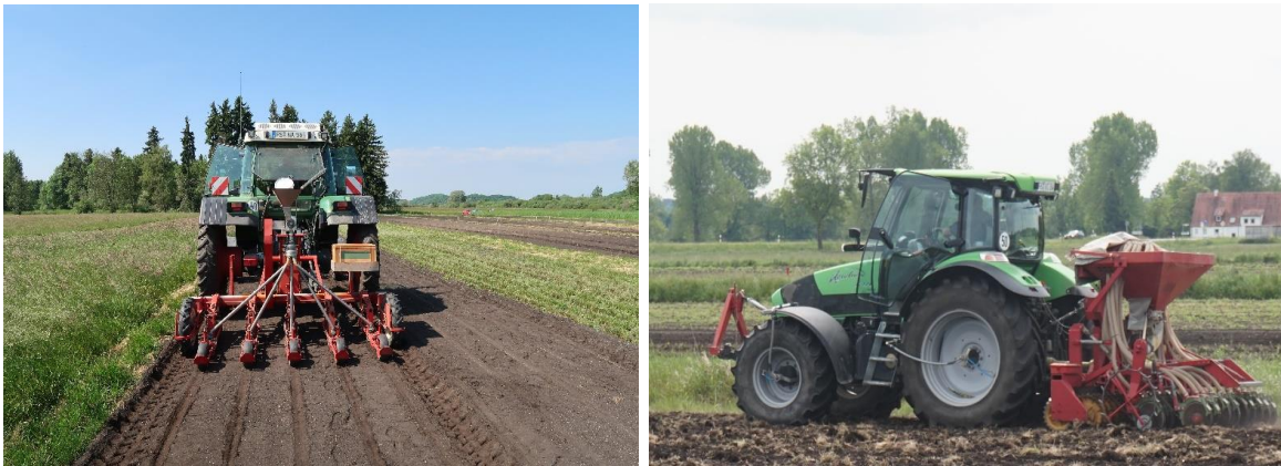
Abb. 3 Linkes Bild: Fünfreihe Spezialsaatmaschine (Anfertigung durch die LfL Landtechnik) für Saatstärken von < 2 \text{ kg ha}^{-1} . Rechtes Bild: Universaldrillmaschine während der Einsaat von Rohrglanzgras am Untersuchungsstandort Riedhausen.
