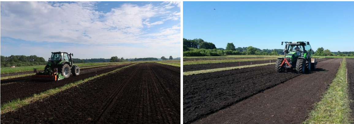
Abb. 2 Linkes Bild: Mit Hilfe eines Kreiselgrubbers wird ein feines Saatbett erstellt. Rechtes Bild: Unmittelbar vor der Pflanzung bzw. Aussaat wird das Saatbett mit einer Wiesenwalze verdichtet.
