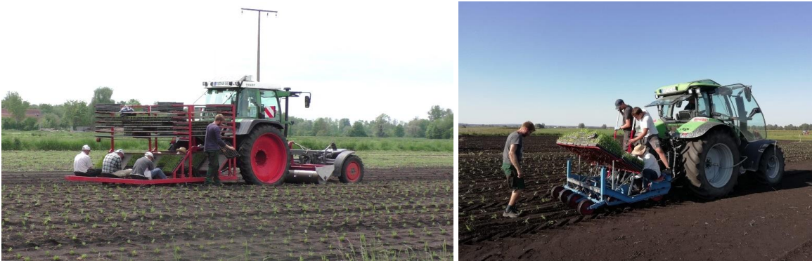
Abb. 4 Linkes Bild: Maschinelle Pflanzung von Carex acutiformis am Versuchsstandort Riedhausen. Über die Vorlaufwalze werden die Pflanzlöcher im definierten Reihen- und Pflanzabstand in den Boden gedrückt. Hier im Bild werden fünf Reihen mit einem Abstand von 0,5 m parallel bepflanzt. Die Pflanzleistung liegt bei ca. 4000 Pflanzen pro Std. Rechtes Bild: Maschinelle Pflanzung von Carex acutiformis am Versuchsstandort Langenmosen mittels einer Gemüsepflanzmaschine. Trotz zweimaligem Walzen der Fläche war der Bodenwiderstand zu gering für diese Maschine was zu einem Verstopfen der Schare führte.
