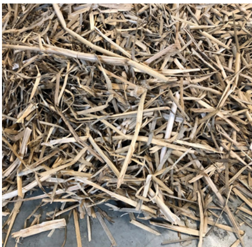
Abbildung 91 Ansicht des aus Mecklenburg-Vorpommern gelieferten Material aus Typha latifolia . Das Material wurde direkt nach der Ernte gehäckselt.
