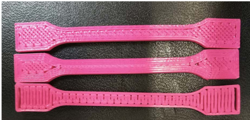
Abbildung 78 3D-gedruckte Prüfkörper aus pinken PLA in den untersuchten Druckrichtungen Diagonal (D) oben, Längs (L) Mitte und Quer (Q) unten
