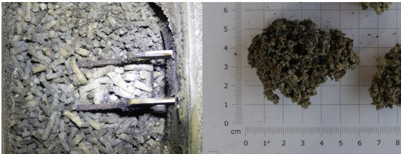
Abbildung 52 Pelletförmige Schlackepartikel nach der Verbrennung von Rohrkolben auf dem Rost des 15 kw Pelletkessels (links) und Schlackebrocken aus Rohrglanzgras aus demselben Kessel (rechts), jeweils ohne Additiv
