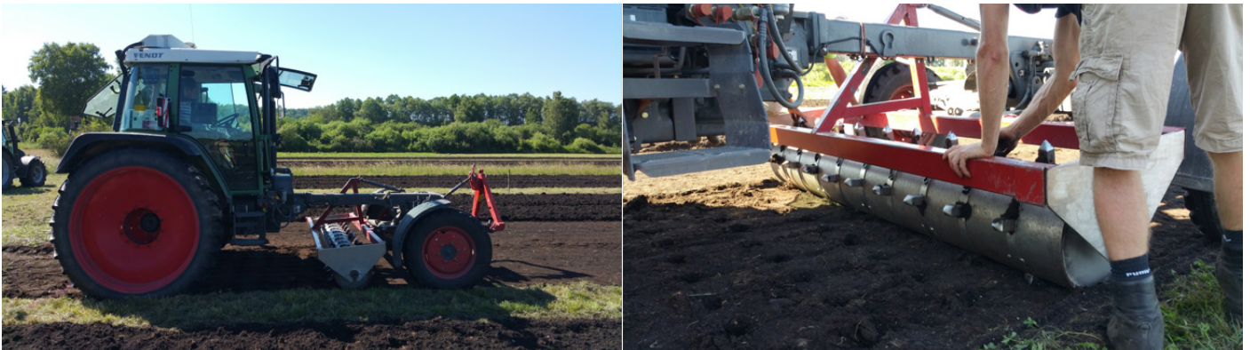
Abbildung 16 Dippelwalze zum Anlegen der Pflanzlöcher. Auf die Walze werden in den gewünschten Reihenabständen Metallringe aufgespannt, welche wiederum mit Metallstempeln ausgestattet sind. Über die Anzahl der montierten Stempel kann der Pflanzabstand in der Reihe eingestellt werden.
