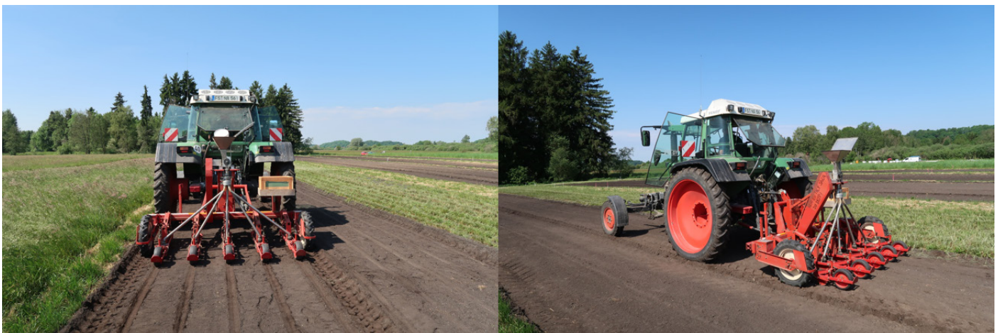
Abbildung 18 Fünfreihege Spezialsaatmaschine (Anfertigung durch die Lfl Landtechnik) für Saatstärken von < 2 kg ha -1 .
