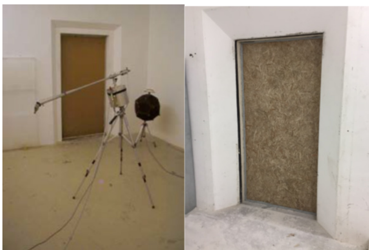
Abbildung 90 Ansicht eines Teils der eingesetzten Messtechnik (links) und die eingebaute und zu vermessende Typhaplatte (rechts).
