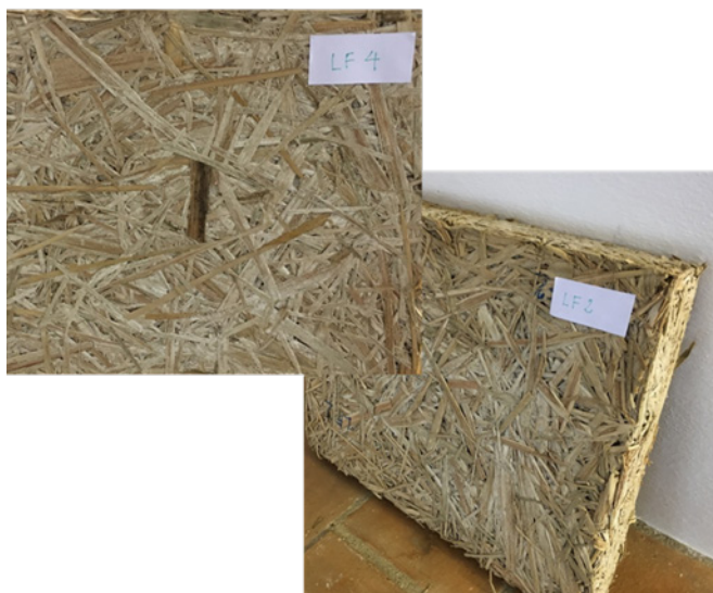
Abbildung 92 Probeplatten mit hoher Rohdichte aus Typha latifolia . Die wesentlichen Herstellungsdaten sind im Bild mit aufgeführt.
