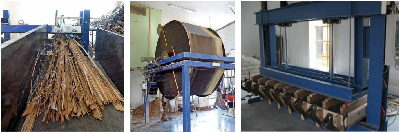
Abbildung 89 Typha -Stäbe nach dem Längsschnitt, Beleimtrommel und Plattenpresse.
